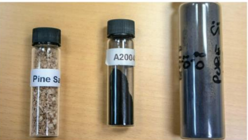
Norsk sagflis (til venstre) blir til karbonpulver med ekstremt stor overflate (i midten). Dette og spesielt utviklede silisumpulver (til høyre) er viktige ingredienser i den nye batteriteknologien. (FOTO: DANK, R. TONNES)
